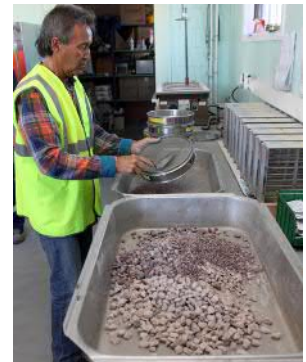
Au laboratoire BTP de la DTAM, le liant bitume est séparé des granulats qui sont criblés pour vérifier la proportion de chaque calibre. Photo - DTAM
